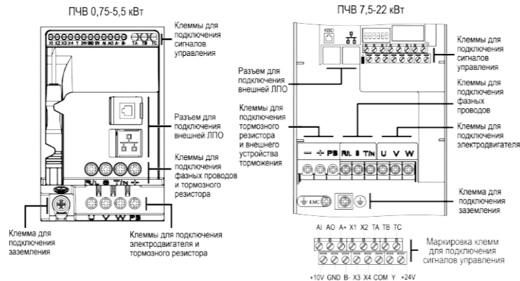
Рисунок 3 – Расположение клемм
